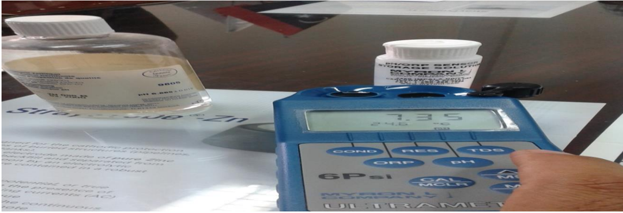
شكل (3) جهاز قياس الرقم الهيدروجيني الذي تم استخدامه عند إجراء الاختبارات الموقعية
