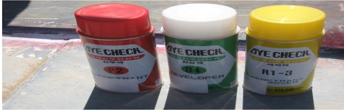
شكل (7) الصبغة النافذة لتحديد شقوق التآكل السطحية
