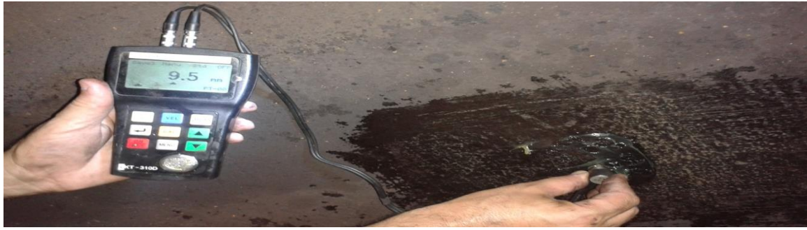
شكل (6) جهاز قياس سمك المعدن الذي تم استخدامه عند إجراء الاختبارات الموقعية
