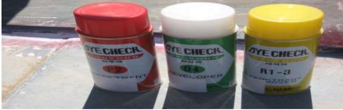
شكل (7) الصبغة النافذة لتحديد شقوق التآكل السطحية
