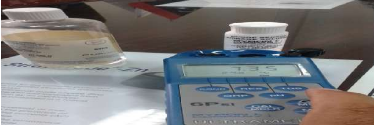
شكل (3) جهاز قياس الرقم الهيدروجيني الذي تم استخدامه عند إجراء الاختبارات الموقعية
