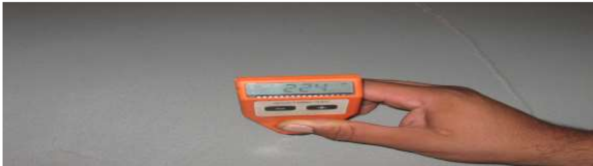
شكل (5) جهاز قياس سمك الطلاء الذي تم استخدامه عند إجراء الاختبارات الموقعية.
